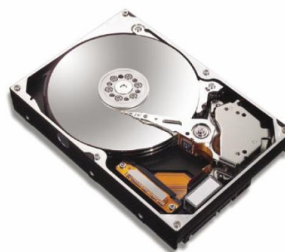
L'intérieur constitué d'un empilement de disques et de têtes de lecture
